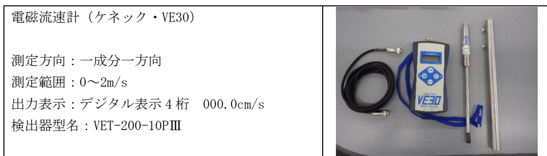
図 3. 4. 13 使用する流速計の規格・性能
