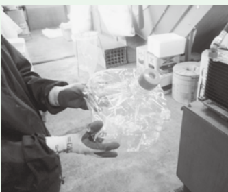
↑分別がされていないために施設設備から取り除いたもの一例
